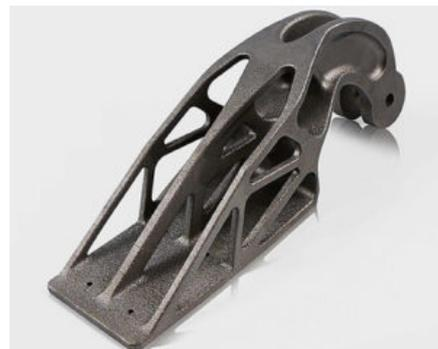
Un componente di un Airbus realizzato in Ti 6Al4V da EOS con tecnologia DMLS nell'ambito di una collaborazione tra la società tedesca specializzata in stampanti 3D di metalli e Airbus Group Innovations per verificare i vantaggi e gli svantaggi della manifattura additiva rispetto a quella tradizionale.
