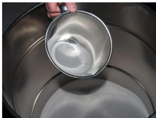
Polvere di Ti 6Al4V pronta per essere inserita in una stampante 3D di metalli per realizzare una pala di un rotore di turbina di aereo nello stabilimento di Cameri (NO) di Avio Aero.
