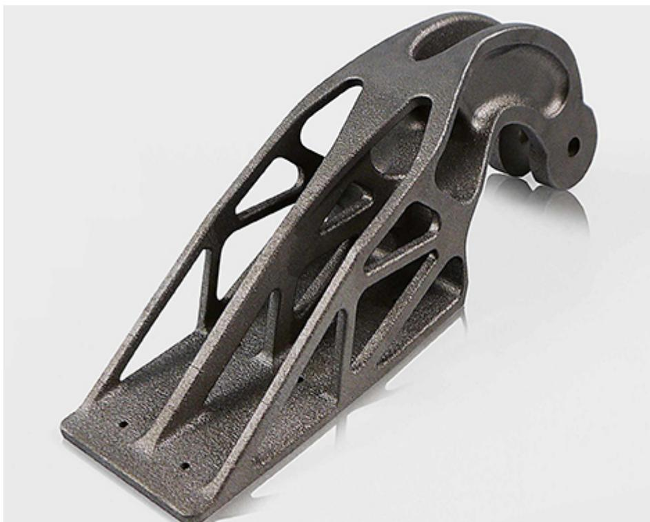
Un componente di un Airbus realizzato in Ti 6Al4V da EOS con tecnologia DMLS nell'ambito di una collaborazione tra la società tedesca specializzata in stampanti 3D di metalli e Airbus Group Innovations per verificare i vantaggi e gli svantaggi della manifattura additiva rispetto a quella tradizionale.
